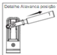
4 – Mantenha todas as válvulas A, C e D fechadas e a alavanca 'E' na posição 1 (levantada).
